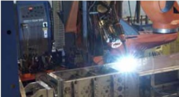
Zdjęcie 1: Firma Driescher-Wegberg wykorzystuje system robotów CLOOS do spawania obudów systemów rozdzielczych.
