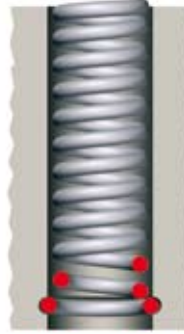
4. Z powiększonym ostatnim zwojem w celu osadzenia w rowku
