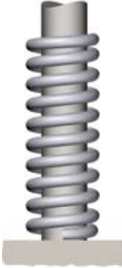
2. Niezeszlifowana, z wewnętrznym elementem ustalającym
