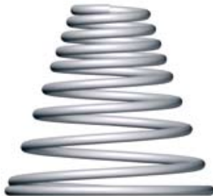
7. Stożkowa sprężyna naciskowa umożliwiająca uzyskanie charakterystyki progresywnej
