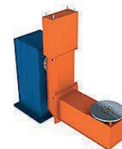
Pozycjoner typu L z dodatkowym skokiem pionowym QR-WP-TSV- 100kN, detal do około 6m, skok pionowy 1,5m
