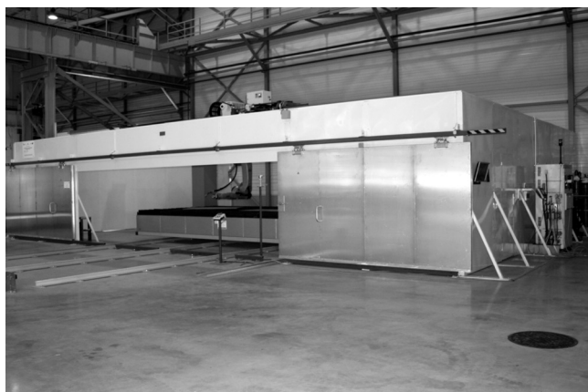
Rys 5. Pierwsze w Polsce przemysłowe zrobotyzowane stanowisko do spawania hybrydowego
