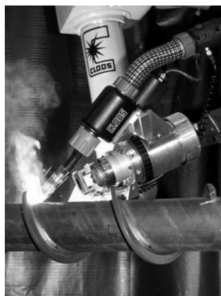
Rys. 5. Głowica do spawania hybrydowego wyposażona w dodatkową oś
