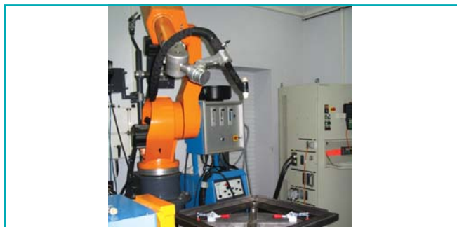
Rys. 5 Zrobotyzowane stanowisko do spawania plazmowo-proszkowego
