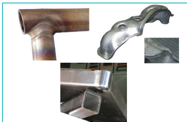
Rys. 1 Przykłady elementów wykonanych z wykorzystaniem techniki spawania plazmowo-proszkowego
