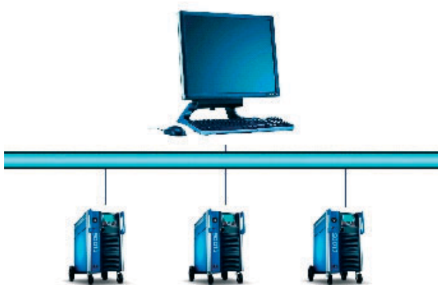
Rys. 1. Podłączenie urządzeń spawalniczych do systemu QDM za pomocą sieci Ethernet
