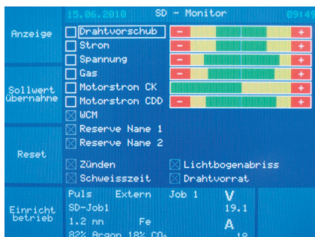
Rys. 2. Ekran nadzoru parametrów - urządzenie spawalnicze
