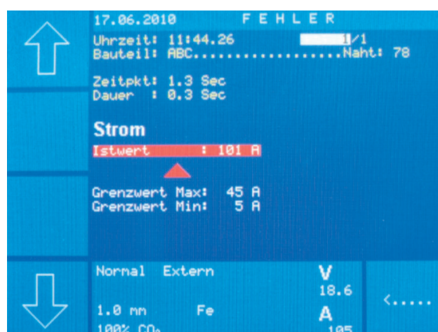
Rys. 5. Szczegóły błędu - ekran urządzenia spawalniczego
