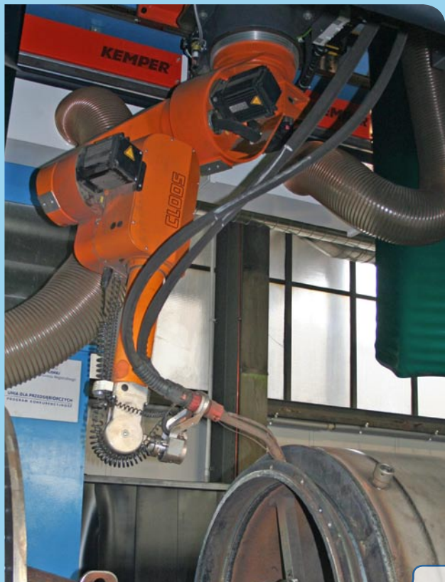
Zrobotyzowane stanowisko do spawania chłodnic metodą TANDEM
