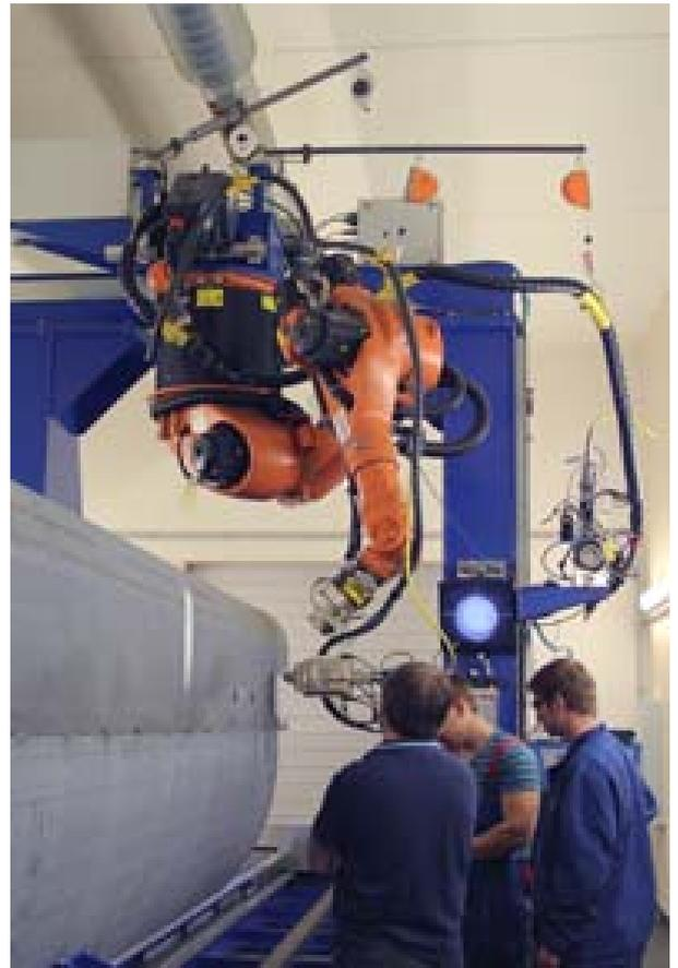
Der CLOOS QIROX-Roboter mit seinen 7 Achsen hängt unter einem Portal, das auf einem exakten Schienensystem durch die 26 m lange Kabine fährt. Bearbeitet wird in PC-Lage, also auf 3 und 9 Uhr, so dass der Ausleger nicht gedreht werden muss.
