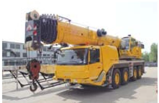
Gut 500 Autokrane der Marke GROVE verlassen pro Jahr das Manitowoc-Werk in Wilhelmshaven. Deutlich zu sehen ist der Aufbau des gelben Kranauslegers mit den ineinander geschobenen, grauen Teleteilen. Bis 135 m Hakenhöhe – in Kombination mit einer Gitterverlängerung – ist damit möglich.
