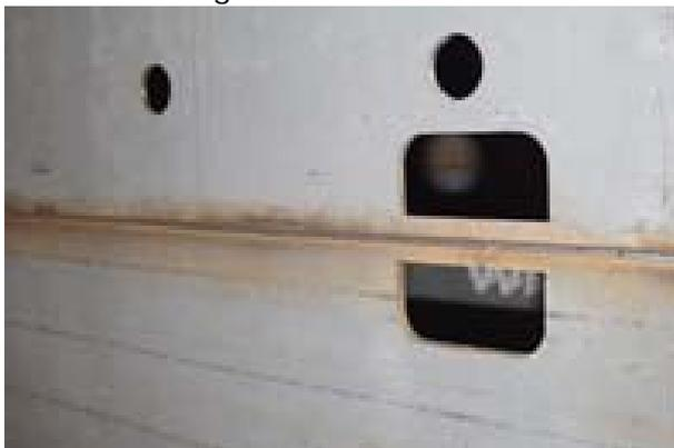
Saubere Schweißnähte liefert der Laserhybrid-Kopf mit minimaler Nahtvorbereitung und Nacharbeit. Der Laser-Schneidkopf bringt alle Bohrungen und Ausbrüche entlang des Auslegers binnen weniger Minuten ein.
