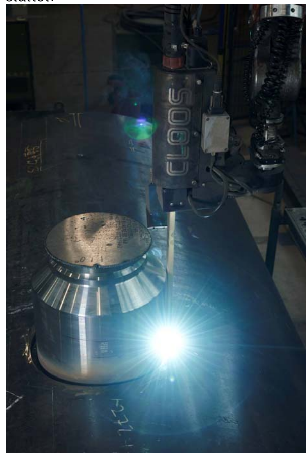
Das rechteckige 400 mm lange Engspaltschwert ist das Kernstück der Engspalttechnik und kann in besonders tiefe Spalten eintauchen.
