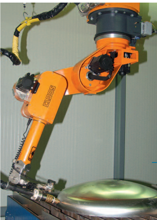
Bild 4. Am steifen Ausleger des Portals ist der sechsachsige Roboter für das Plasmaschneiden hängend angeordnet.
