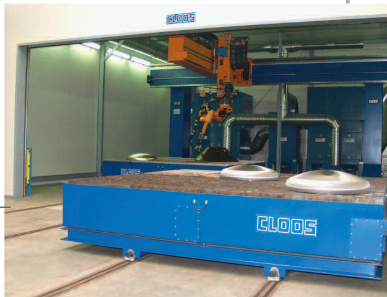
Bild 3. Die Plasmaschneidanlage wird über zwei jeweils 4 m lange und breite Schneidtische beschickt, die für große Teile auch gekoppelt benutzt werden können.
