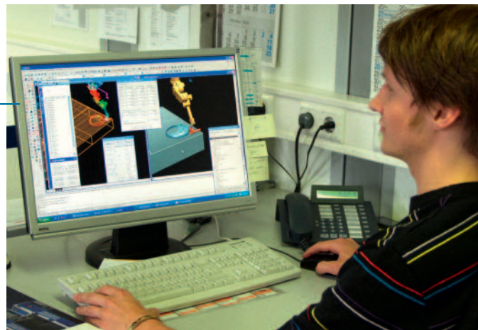
Bild 8. Das bedienerfreundliche Offline-Programmiersystem „MOSES“ dient dazu, die jeweiligen Ausschnitte für die individuellen Behälterbauteile zu programmieren, zu simulieren und die Daten an den Schneiroboter und die Plasmaschneidanlage zu übertragen.
