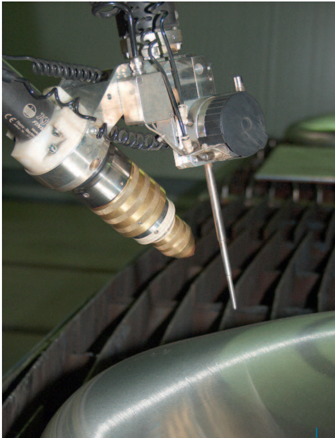
Bild 5. Vor dem Schneiden führt der Roboter einen Taststift über das Bauteil – hier einen Klöpperboden – und ermittelt damit dessen Position auf dem Schneidstisch sowie die individuellen Abmessungen.
