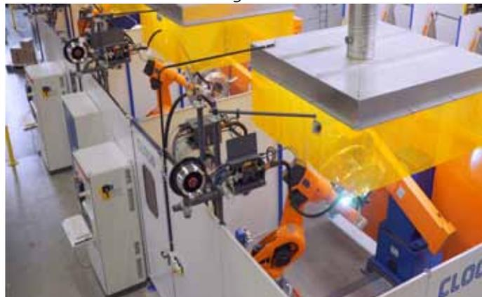
Bild 5: Die Roboter in den drei baugleichen Zellen schweißen mehr als doppelt so schnell wie ein Handschweißer.
