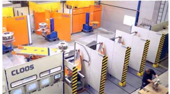
Bild 2: Die verkettete Roboteranlage verfügt über vier Be- und Entladestationen sowie drei Schweißzellen.
