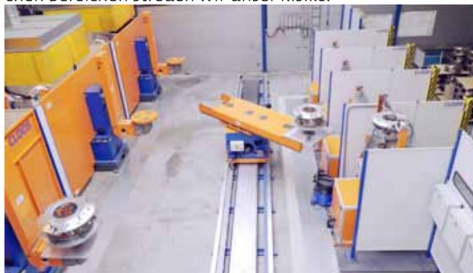
Bild 1: Herzstück der komplexen Anlage ist das intelligente Shuttlesystem, welches die einzelnen Stationen miteinander verbindet.
